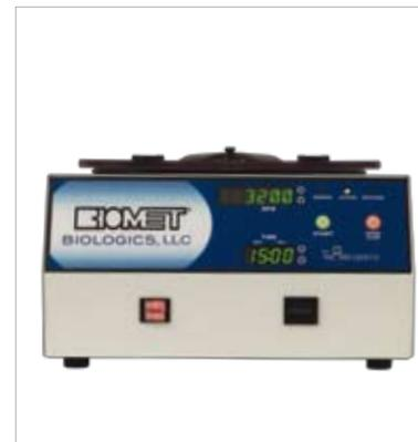
Der Trennbehälter wird 15 Minuten bei 3.200 Umdrehungen pro Minute zentrifugiert.
